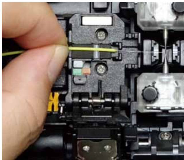
図5 新しい補強スリーブ位置決め機構 Fig. 5. New sleeve positioning structure.
