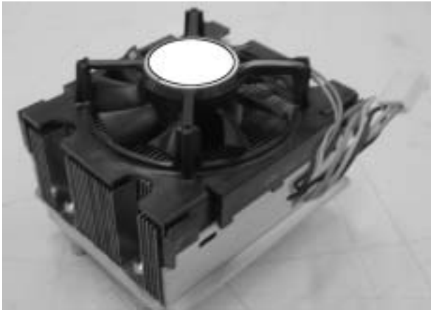
Fig. 10. Fan sink for cooling sever.
