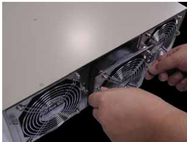
図 5-5 ファンユニットの実装方法
