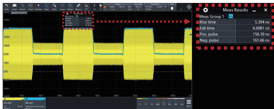
図15 256素子PAAMのビームスイッチング時間
