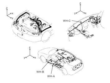
**図4** ワイヤハーネス車両配策例 Example of wiring harness equipment
