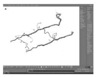
図1 WH 3D CADモデル WH 3D CAD model
