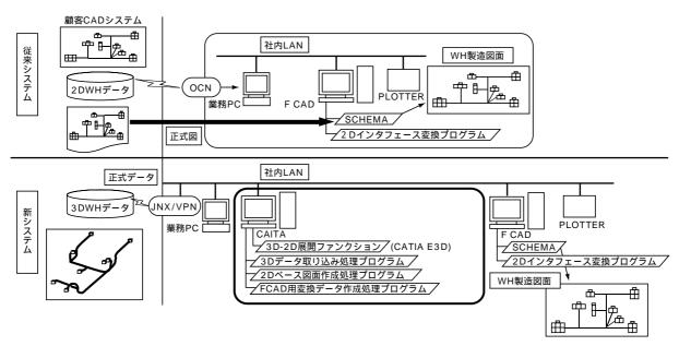
図3 3D-2D変換CADシステム構成 3D-2D interface CAD system component
