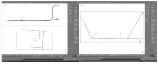
図5 2D展開結果およびWHレイアウト修正結果 Result of 3D-2D conversion and WH bundle layout modification
