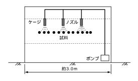
図4 耐水性試験方法
