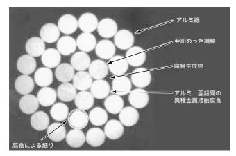
図2 塩水噴霧試験後のACSRの横断面 Cross section of ACSR after salt spray test
