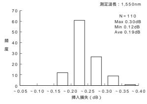
図9 小型コリメータの挿入損失ヒストグラム Histogram of miniature collimators insertion loss
