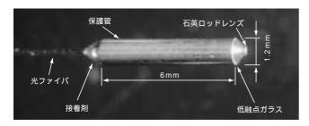
図10 小型コリメータの外観 External view of miniature collimator
