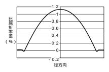
図6 レンズ母材の屈折率分布 Index profile of the lens preform
