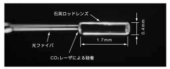
**図7** 光ファイバと石英ロッドレンズの融着 Splice between optical fiber and silica rod lens
