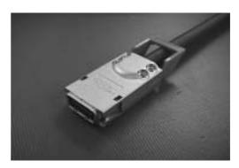
図2 InfiniBand™ 4Xコネクタ
