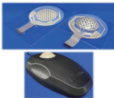
立体静電トラックパッド (上：平面回路の立体化 下：立体回路を組み込んだトラックボール)
