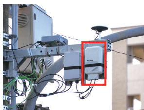
姫路市安全運転支援実証での当社60GHzミリ波無線通信装置（屋外評価キット）
