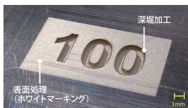
● 銀板(厚み1mm)に対する深堀加工(溝深さ0.5mm)
