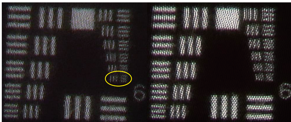
高解像度イメージファイバ伝送画像(左: 開発品, 右: 従来品)
