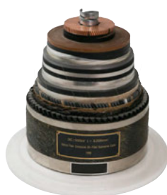
「未来技術遺産」に登録された 世界初の長距離大容量直流±500 kV海底OFケーブル
