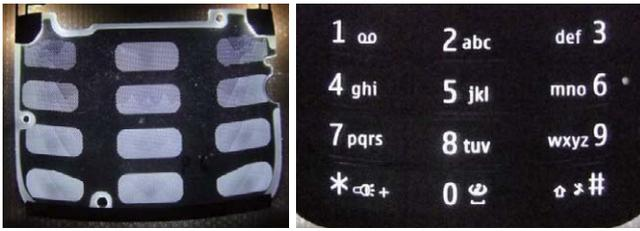
図 11 微細照光拡散ドットを有するフレキシブル導光フィルムの照光写真とそれを用いたキーボードの写真
