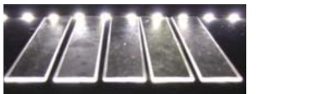
b) UV照射後の開発フレキシブル導光フィルムの外観
