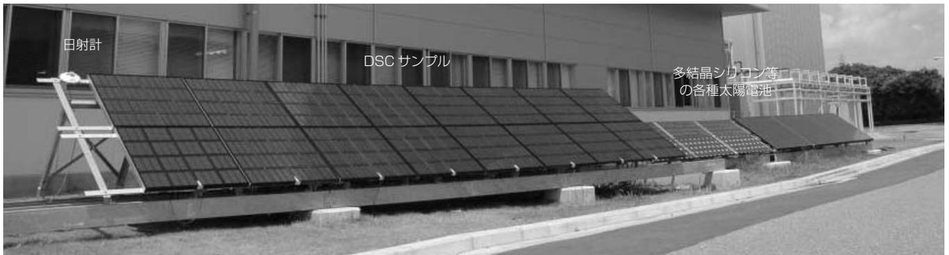
図4 屋外測定システムの外観
