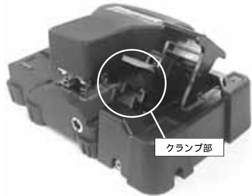
図10 斜め切断光ファイバカッタ
