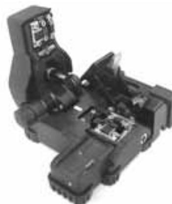
図2 斜め切断光ファイバカッタ
