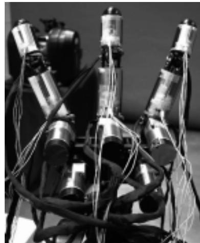
図3 触覚センサを組み込んだロボットハンド
