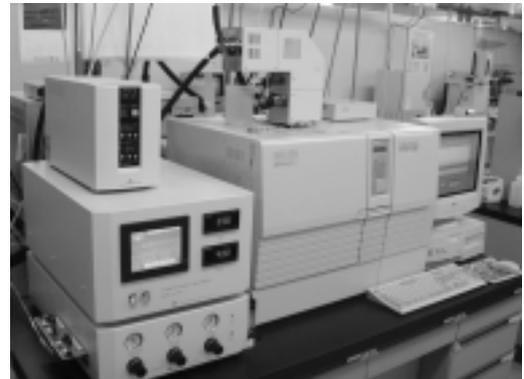
図3 アウトガス測定装置 VOC measurement equipment
