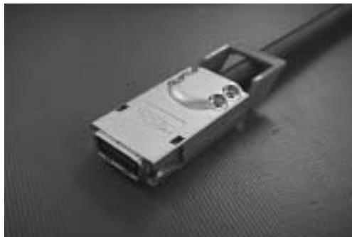
図2 InfiniBand™ 4Xコネクタ
