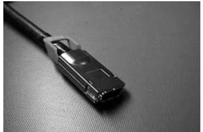
図8 InfiniBand ケーブルアセンブリ
