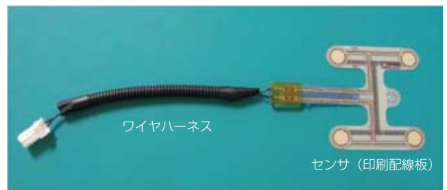
図4 シートベルトリマインダ用着座センサ Fig. 4. Occupant detection sensor for seat-belt reminder system.
