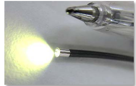
例) 極細径φ1.3mm CMOS内視鏡
