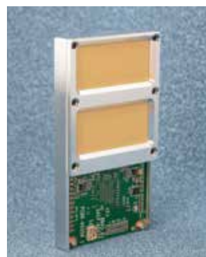
60GHzミリ波無線通信モジュール
