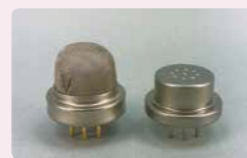
小型酸素センサ 左が従来品、右が開発品
