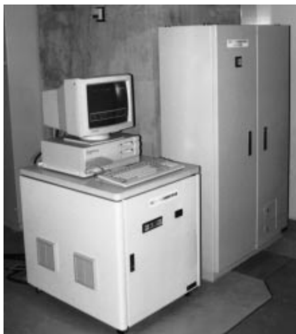
図10 高圧ケーブル活線絶縁診断装置
