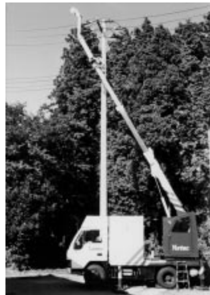
図11 碍子洗浄ロボット
