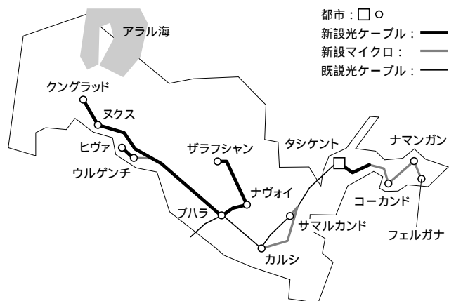
図9 ウズベキスタン基幹通信ネットワーク
