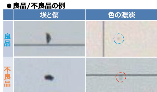
図10 レーザダイオードウエハ外観検査判定例 Fig. 10. Example of judgment.
