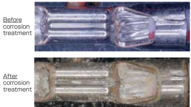
図2 腐食処理前後の端子圧着端末部の外観
