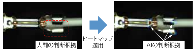
図6 ヒートマップによる判別根拠の可視化 Fig. 6. Visualization of judgement basis of AI by heat map.
