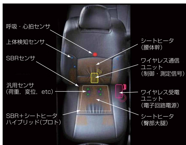
図5 コンセプトイメージ Fig. 5. Concept Design Image of Hybrid Device.
