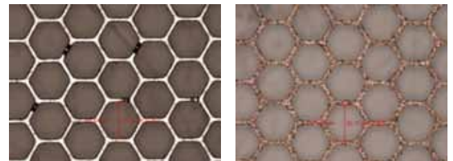
図5 製作した微細電極フォイル (左：F面，右：B面) Fig. 5. Micrograph of fine electrode foil fabricated by nickel plating.
