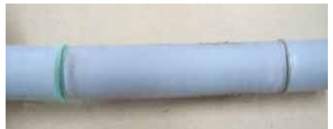
図3 トラッキング試験後試料 Fig. 3. Test piece after tracking test.
