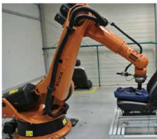
図10 シート耐久試験ロボット
