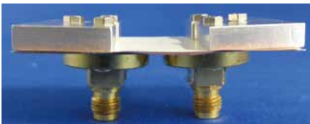
図2 試作した導波管-マイクロストリップ線路変換のBack-to-Back構造 Fig. 2. Fabricated waveguide to microstrip-line transition.
