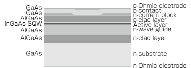
図1 LDの断面構造
