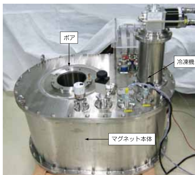
図3 超電導マグネットの構成例 (フジクラ製) Fig. 3. Photograph of superconducting magnet.
