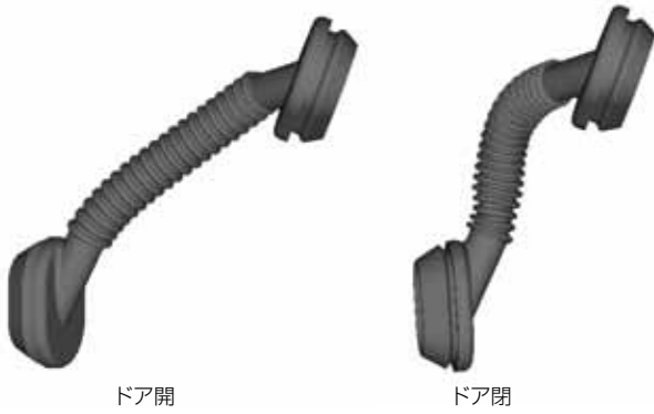
図7 グロメット単体の変形解析 Fig. 7. Deformation analysis of grommet.
