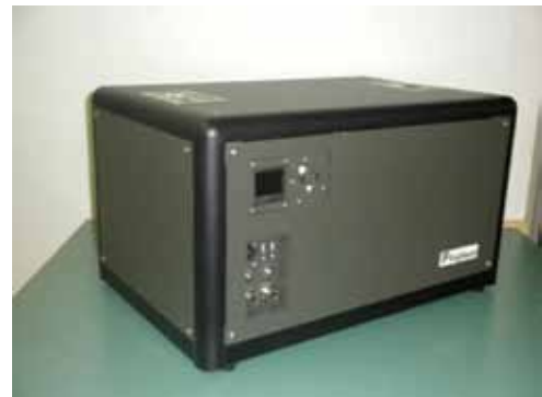
図7 1 kW DMFCシステム外観写真 Fig. 7. Photograph of 1 kW DMFC system.
