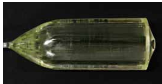
図3 大型TSLAG単結晶 Fig. 3. TSLAG single crystal.
