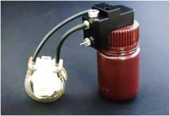
図10 取り外されたUV樹脂ポンプとタンク Fig. 10. Removed UV Curable Resin Pump and Tank.
