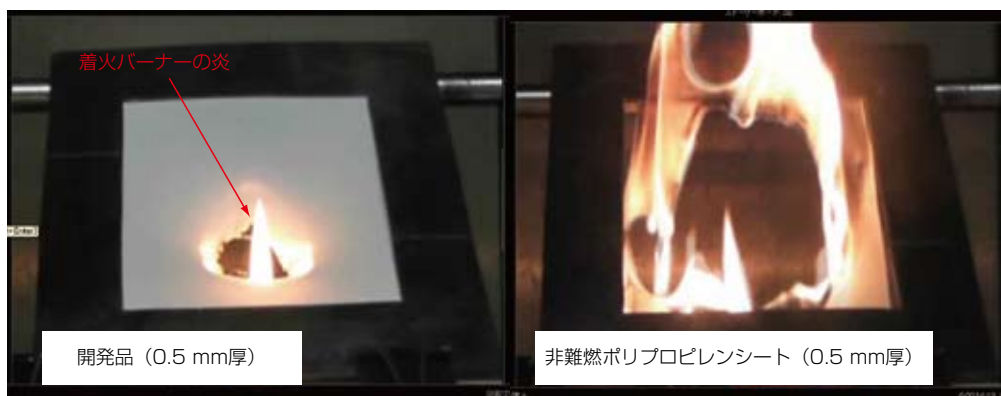
図 2 JIS A1322 難燃性試験 Fig. 2. Flame test on the sheet (JIS A1322).
