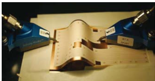
図11 導波路曲げに対するミリ波伝送評価系 Fig. 11. Measurement setup for bended PWW.
