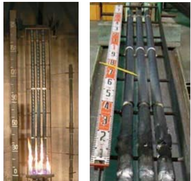
図4 垂直トレイ燃焼試験 (JIS C3521). Fig. 4. Vertical tray flame test of proto type cable (JIS C3521).
