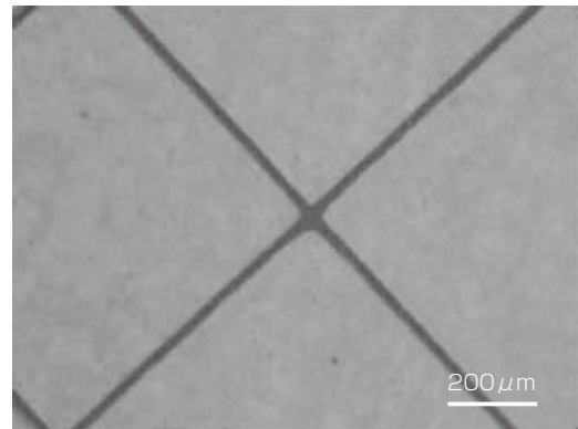
図9 透明電極用微細銀メッシュパターン (L/P = 20 μm / 1000 μm) Fig. 9. Fine Ag mesh traces for transparent electrode.
