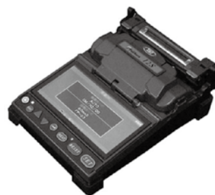
図1 FTTH用小型光ファイバ融着接続機 Fig. 1. Appearance of new fusion splicer.
