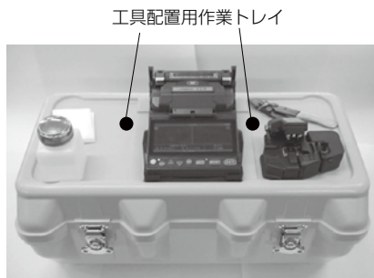
図6 上蓋を利用した接続作業
