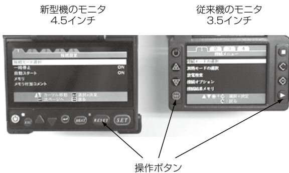
図2 表示モニターと操作ボタンの比較 Fig. 2. Comparison of monitor & operation buttons.
