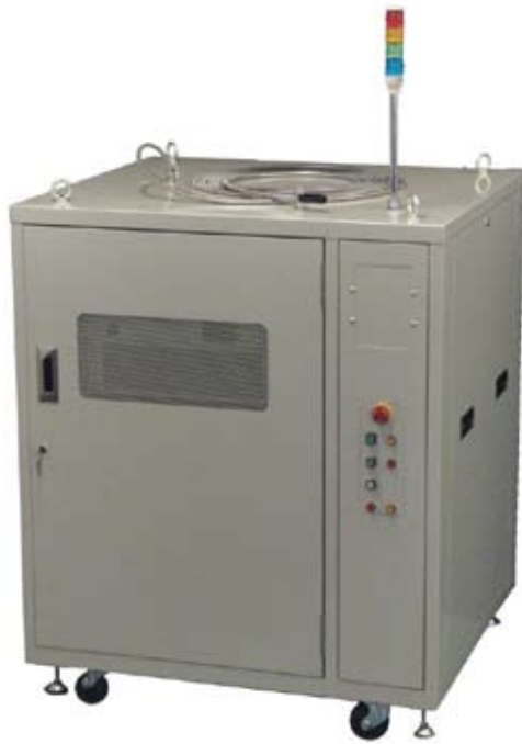
図5 水冷2 kW 連続波マルチモードレーザー試作機の外観 Fig. 5. Appearance of water-cooled continuous-wave multimode fiber laser prototype.
