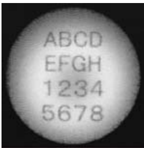
図3-1 耐放射線性ファイバースコープ伝送画像 Fig. 3-1. Transmitted image (Numeric character chart).
