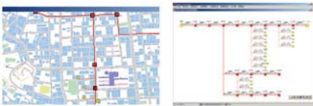
図8 心線管理システム 地形図および系統図 Fig. 8. Optical network database management System with geographical map.
