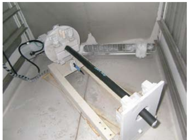
図9 低温捻回試験状況 Fig. 9. Twisting test under -30 ℃.
