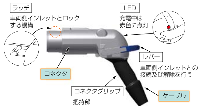
図3 コネクタ構造 Fig. 3. Structure of the connector.
